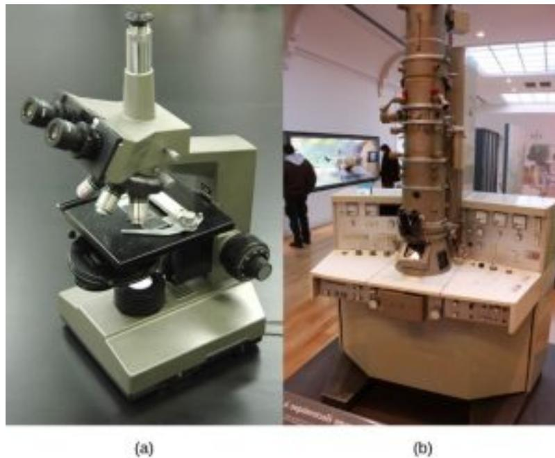
**Figure 4.2** (a) La plupart des microscopes optiques d'un laboratoire de biologie peuvent grossir les cellules jusqu'à environ 400 fois et ont une résolution d'environ 200 nanomètres. (b) Les microscopes électroniques permettent un grossissement beaucoup plus important, 100 000 fois, et ont une résolution de 50 picomètres. (crédit (a) : modification du travail par « GcG »/Wikimedia Commons ; crédit (b) : modification du travail par Evan Bench)
