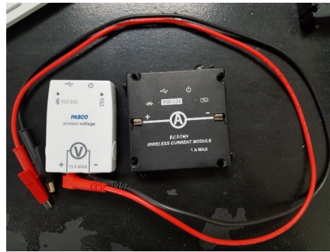
Digital Voltmeter & Ammeter
